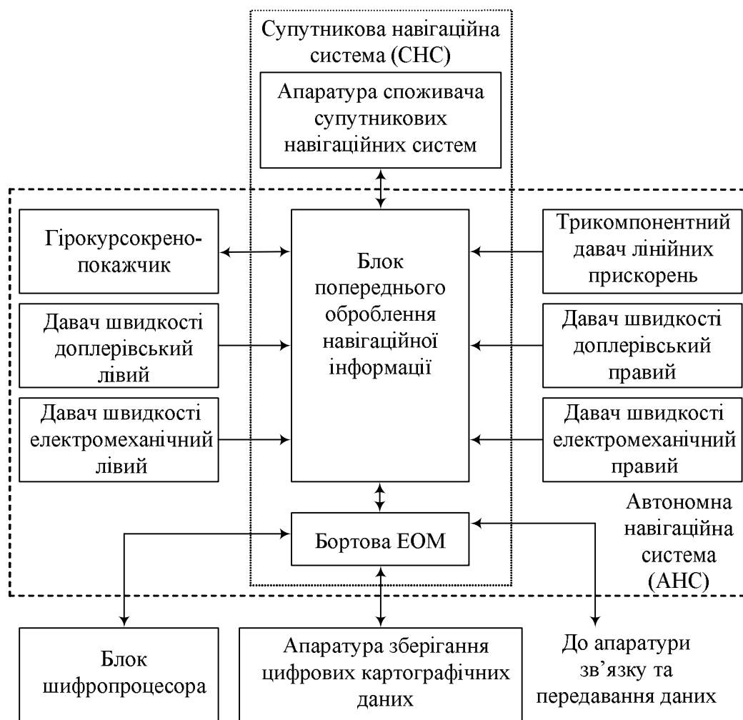
Структура інтегрованої системи навігації наземного рухомого об'єкта
