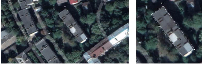
Рис. 2. Детектування контуру будівлі
