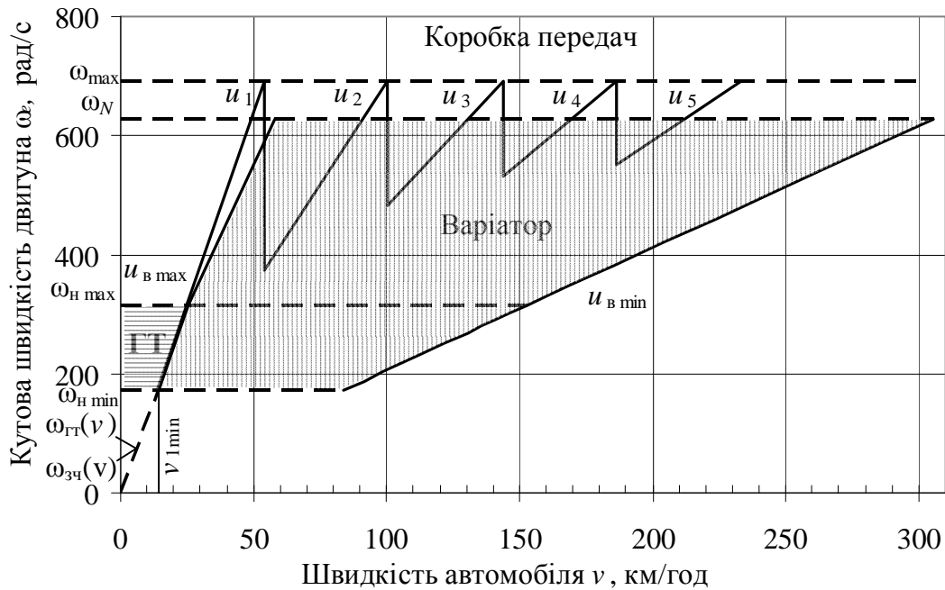
Рис. 4. Робочі діапазони дискретно-змінної і неперервно-змінної трансмісії
