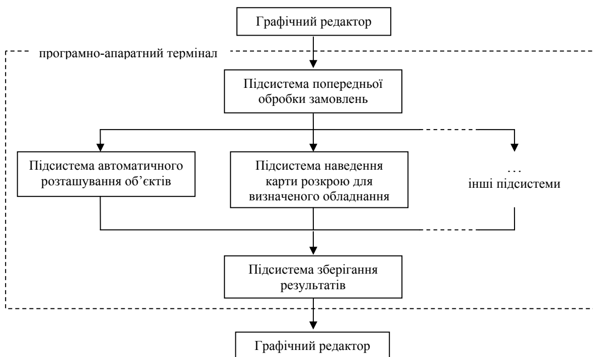
Рис. 1. Спрощена функціональна схема Веб-орієнтованої системи розкрою матеріалів
