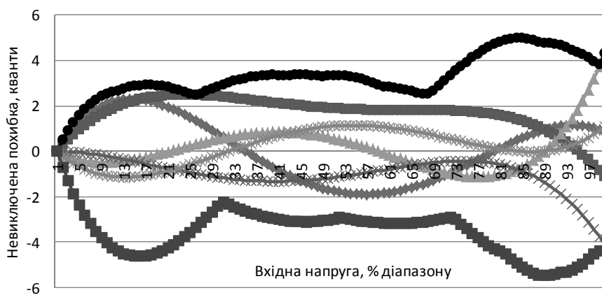
Рис. 5. Залежність невиключеної похибки від вхідної напруги для шуму АЦП \pm 6 квантів
