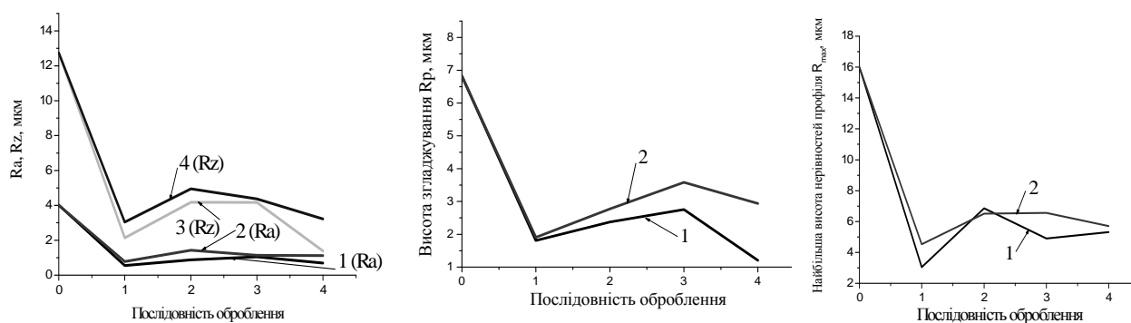
Рис. 3. Зміна висотних параметрів ( R_a , R_z , R_p , R_{max} ) після оброблення деталі ВВЗ
