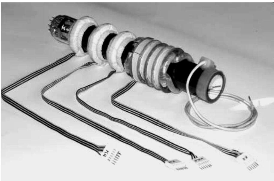
Рис. 2. Блок електронно-променевої трубки У4ТПІІ з фокусувально-відхилювальним комплексом
