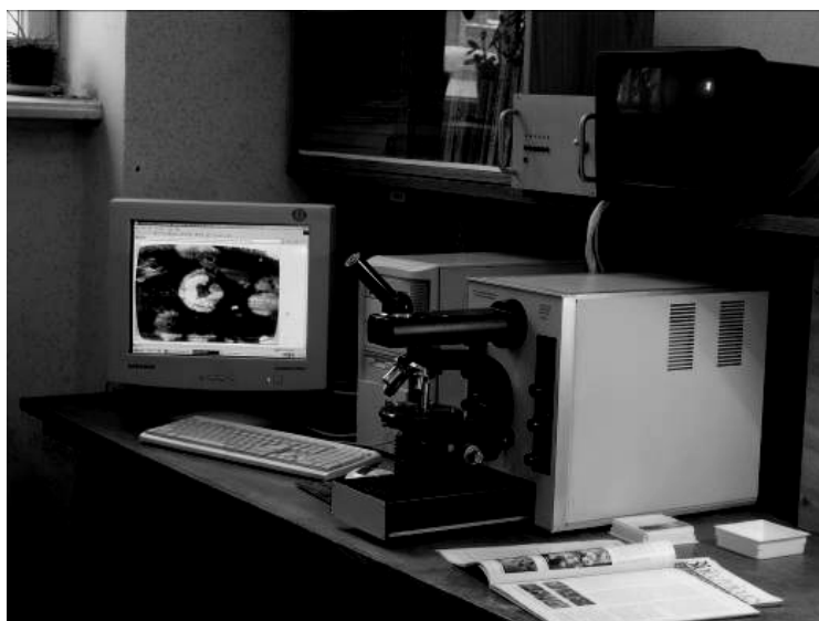
Рис. 1. Лабораторний макет сканувального оптичного мікроскопа на базі електронно-променевої трубки
