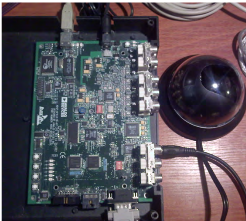
Рис. 2. Тестовий стенд системи покращення якості зображень.
