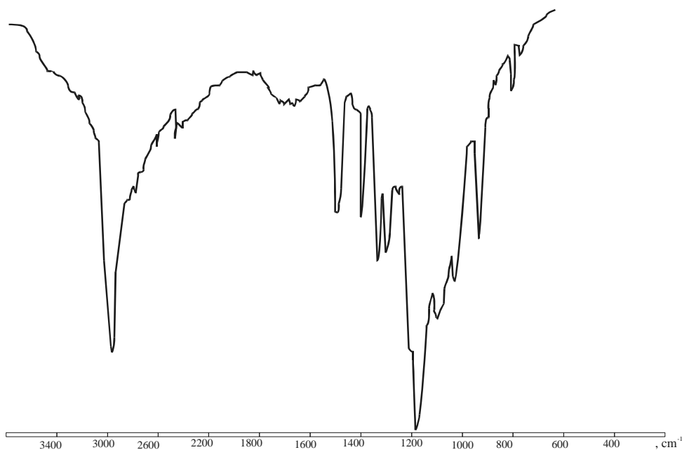
Рис. 1. ІЧ спектр монометилкового етеру поліетиленглікольфосфату 4б
