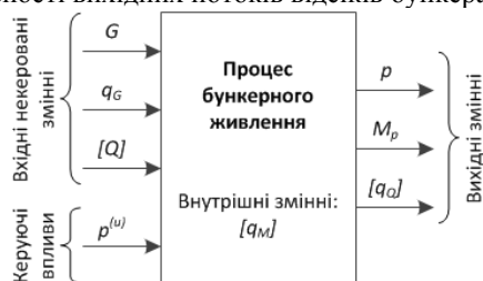
Рис. 1. Процес бункерного живлення як об'єкт автоматизації
