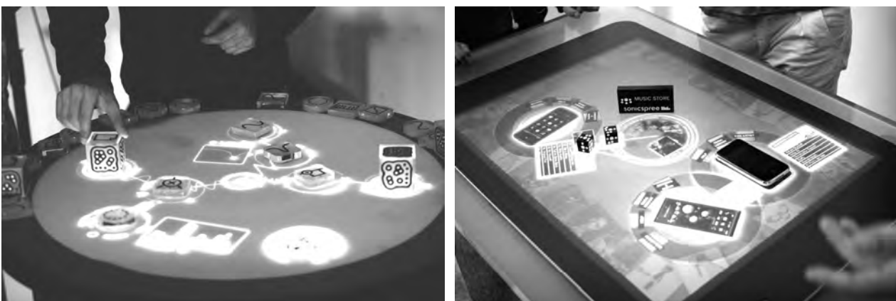
а б Рис. 3. Керування цифровими даними: а – музичного інструменту за допомогою фізичних предметів [6, 7]; б – розпізнавання предметів (фотокамер, телефонів) на Microsoft Surface [8]
